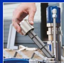
L'ampia superficie di filtraggio riduce le ostruzioni dell'ugello e garantisce una finitura di qualità. Il filtro viene rimosso con il tappo quindi c'è meno disordine.
